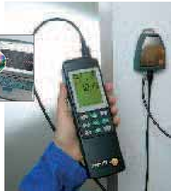
Controllo di trasmettitori con interfaccia da 4 a 20 mA
