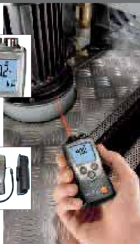
Controllo della temperatura di superficie, ad esempio in motori elettrici
