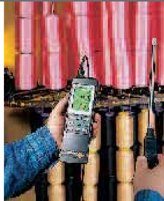
Misura dell'umidità fino a +180\text{ }^{\circ}\text{C} in impianti di essiccamento
