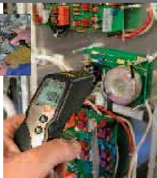
Monitoraggio della temperatura di componenti elettronici
